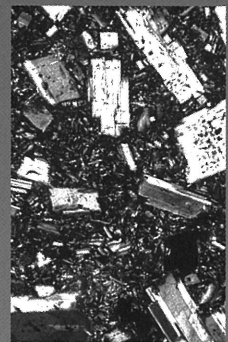
岩石薄片(偏光顕微鏡写真) 安山岩・静岡県富士市岩本 市村毅標本
